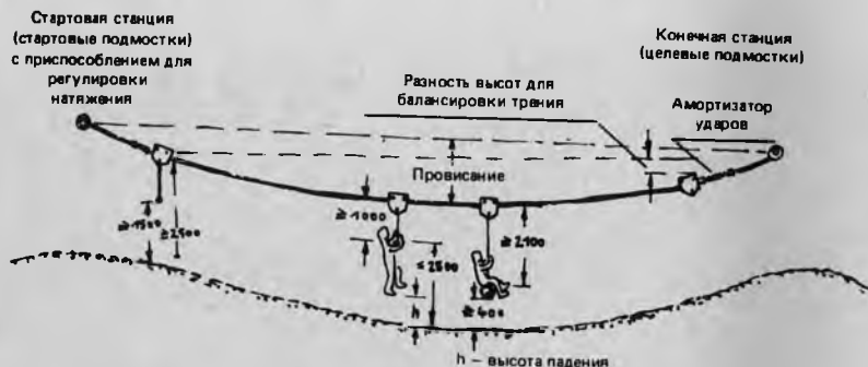
Рис. 58. Принцип работы подвесного оборудования
